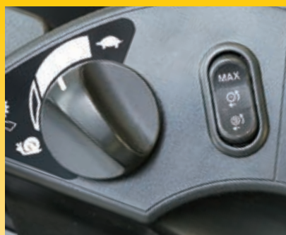
Kontakt for variabel indstilling af krybeinterval af kørehastigheder (venstre) og variabel trækraft kontrolkontakt (højre)
