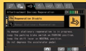
Efterbehandlingsenhed med regenerations-skærm til KDPF
